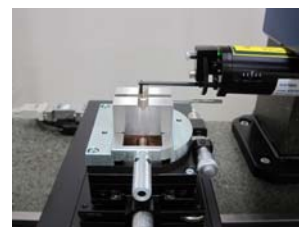
図 6 シャフトを用いたアライメント方法
